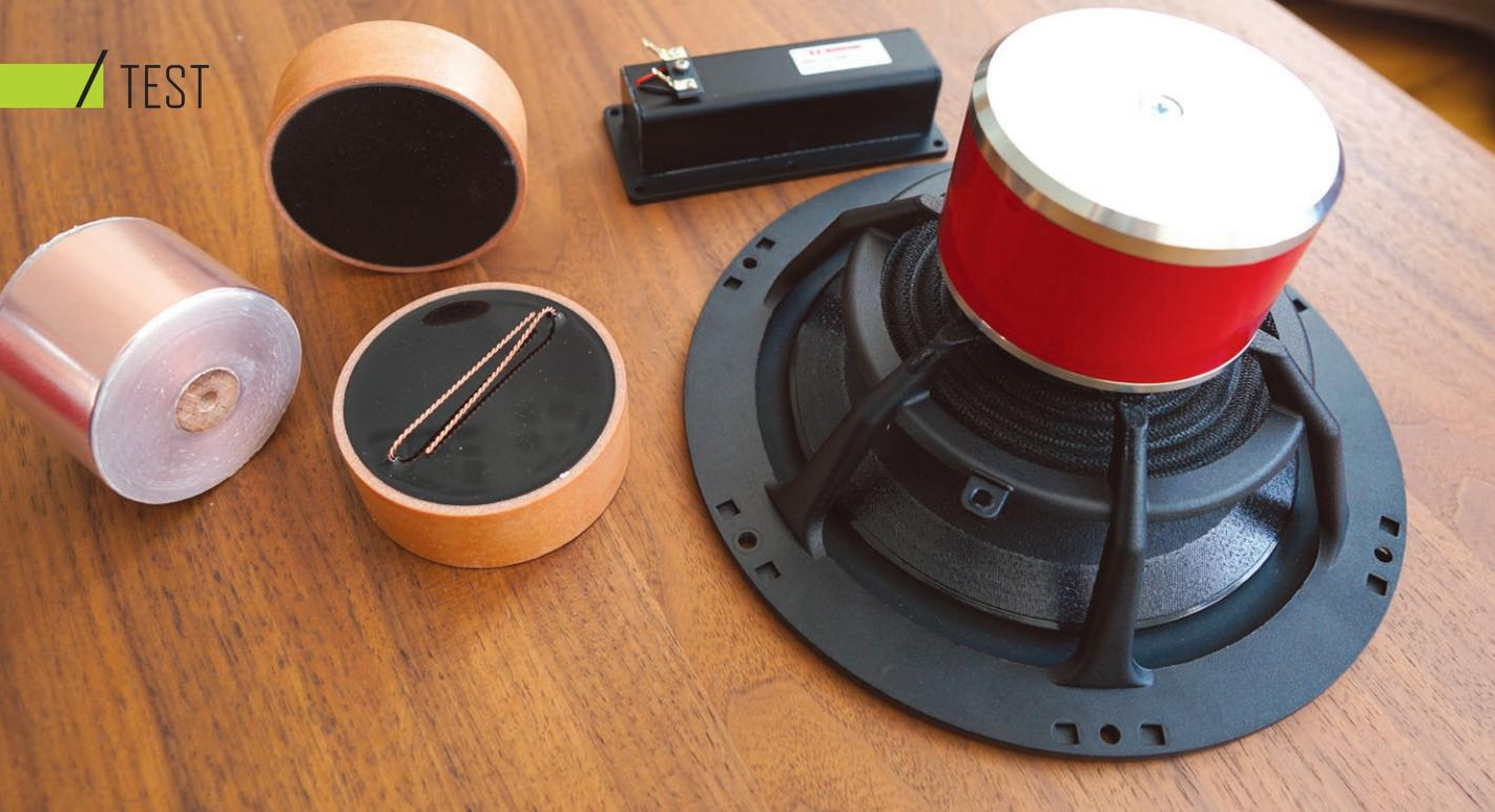
Le haut du spectre est reproduit par un haut-parleur de type AMT issu du catalogue Mundorf. Le ruban plissé du transducteur Air Motion Transformer offre une grande surface de rayonnement acoustique condensée dans un châssis compact pour un très haut rendement et une meilleure gestion de la puissance. L'AMT propose en outre une fréquence de coupure basse qui lui assure un couplage idéal avec le woofer de 21 cm.
